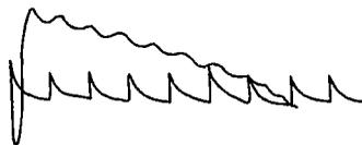
图 CA-9 故障点靠近测试端的波形
