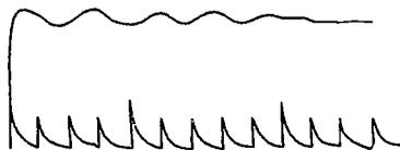
图 CA-5 故障点靠近测试端波形
